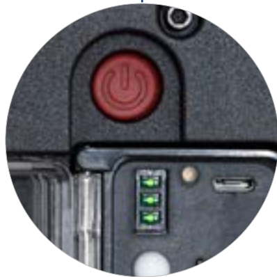
Schalter (OFF | 25 | 50 | 100%) und Ladestandsanzeige
